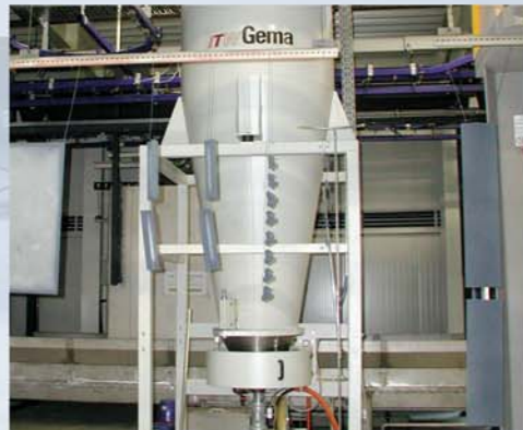
Pulverrückgewinnung mit anschließender Luftreinigung
