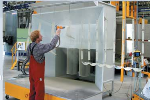
Handbeschichtung für Einzelteile und kleine Losgrößen
